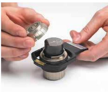
Держатель предназначен для материалографических шлифов диаметром до 32 мм и высотой до 30 мм.
