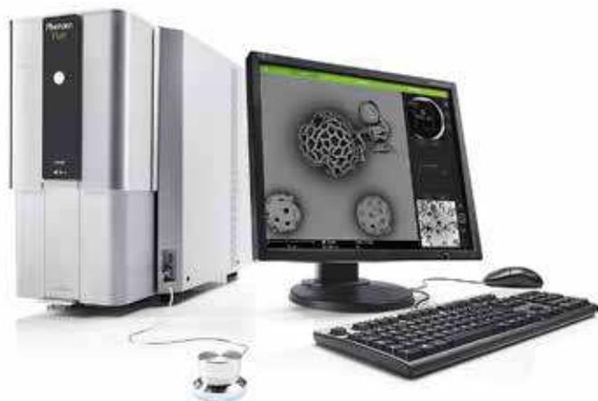
Компактный размер позволяет установить электронный микроскоп в ограниченном пространстве, в любом помещении, а оптическая цифровая навигационная камера, моторизованный предметный стол и дружелюбный интерфейс упростят задачу и помогут в исследовании интересующей области на различных образцах без необходимости нанесения проводящего слоя.
