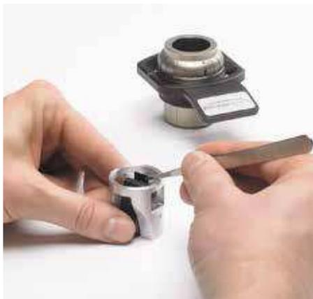
Вставка предназначена для изучения образцов с покрытиями, многослойных образцов и т. п. Специальный механизм крепления позволяет фиксировать образцы без привинчивания или использования дополнительных инструментов и принадлежностей. Устанавливается в держатель для материалографических образцов.
