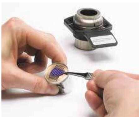
Вставка предназначена для изучения небольших плоских и тонких образцов: металлических и диэлектрических образцов, полупроводников, микроэлектронных компонентов, фотоэлементов солнечных батарей. Уникальный механизм крепления обеспечивает фиксацию образца без приклеивания или контакта с поверхностью. Устанавливается в держатель для материалографических образцов.
