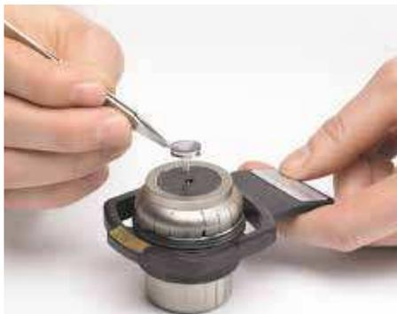
Держатель предназначен для образцов различной произвольной формы. Образцы фиксируются на предметном столике. Диаметр образцов до 25 мм, высота до 30 мм.
