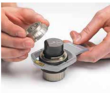
Держатель предназначен для токонепроводящих материалографических шлифов диаметром до 32 мм и высотой до 30 мм. Наличие такого держателя устраняет потребность в дополнительной пробоподготовке токонепроводящих материалографических образцов (шлифов).
