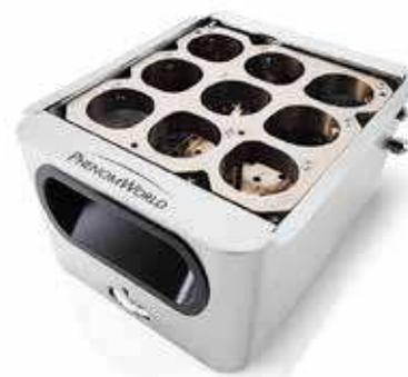
Для зажима залитого образца диаметром 25 мм (1") 9 шт.
